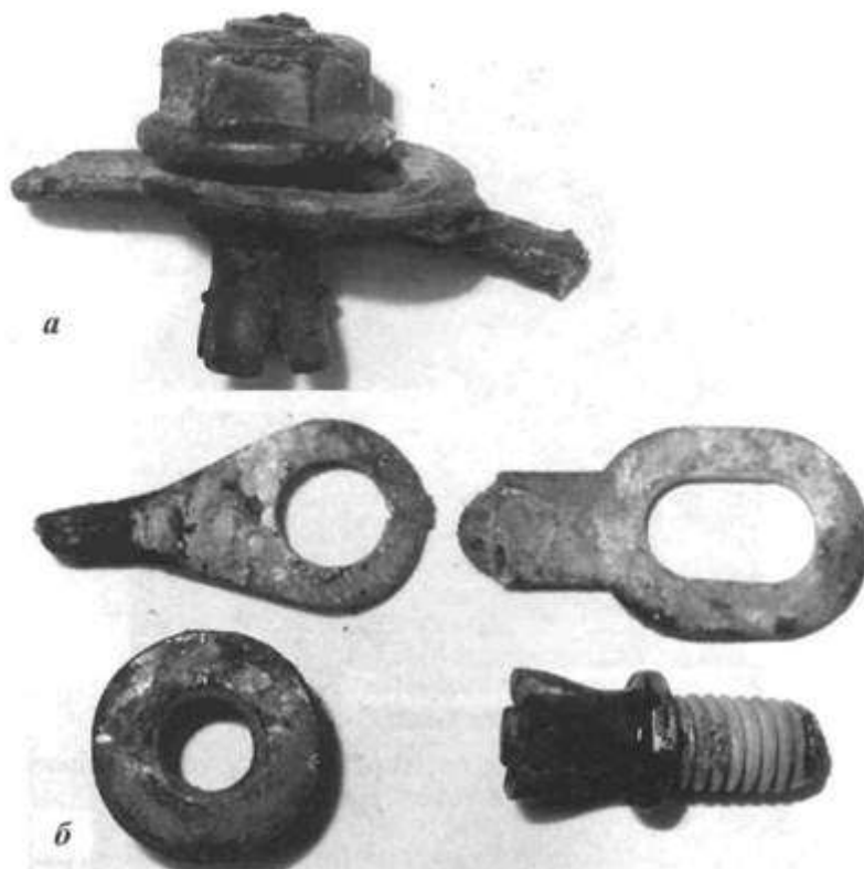
Рис. 28. Болтовое соединение: болт, гайка, два контакта: а - болтовое соединение в сборе; б - болтовое соединение после его разбора на составные части
